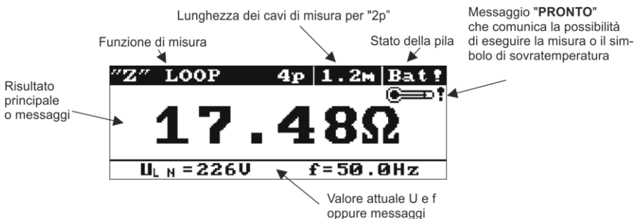
Fig. 4 Layout dello schermo durante la misura dell'impedenza dell'anello di guasto (solo il risultato principale)
