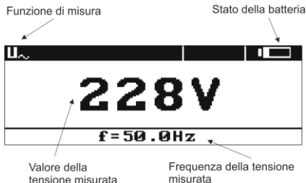
Fig.2. Layout dello schermo durante la misurazione della tensione alternata
